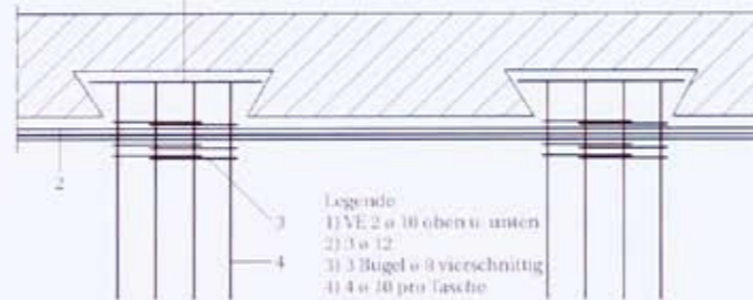
Prinzipausbildung Auflager Decke/vorhandenes Mauerwerk
